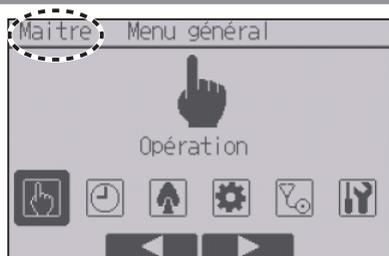
Les paramètres suivants ne peuvent pas être réglés depuis la télécommande secondaire. Faites ces réglages depuis la télécommande principale. "Main" est affiché dans le titre du Menu général sur la télécommande.
