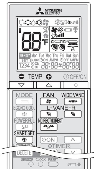
1 Appuyez sur
