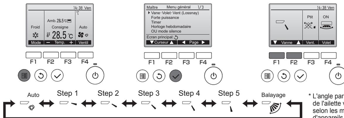
\* L'angle paramétrable de l'ailette varie selon les modèles d'appareils intérieurs.
